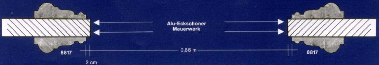
Schnitt durch eine Türbekleidung mit Stuckleisten.
