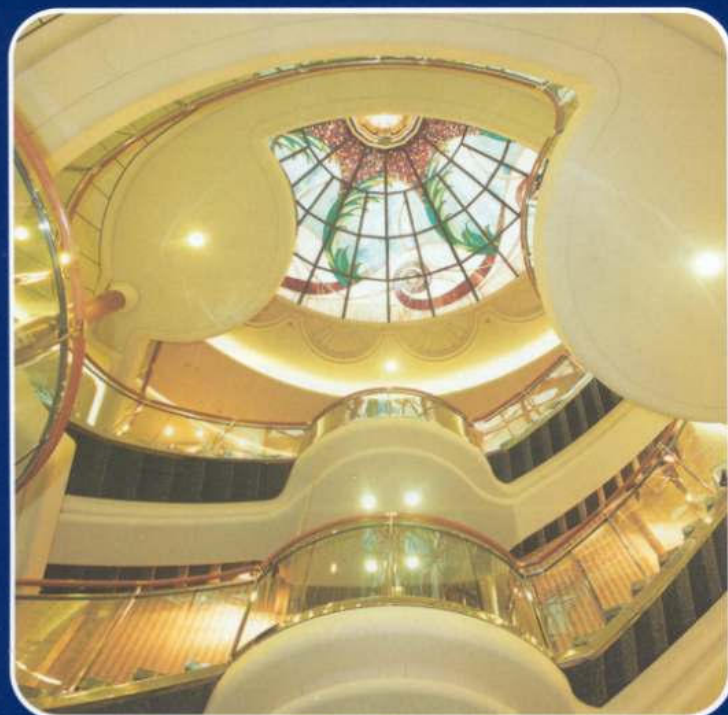
Atrium, indirekte Beleuchtung aus Stuck, hier in Verbindung mit Glas, Edelstahl, Marmor und Granit, in geschwungenem Verlauf mit vielen Radien über acht Decks.
